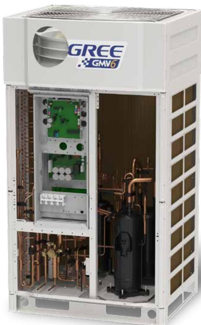
**3 Refrigeración de la electrónica**, gracias a la placa trasera de disipación de temperatura refrigerada por la propia expansión de la unidad exterior, el módulo IPM del compresor está refrigerado 360º, y le permite trabajar al máximo rendimiento en óptimas condiciones.
