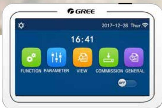
Además, incorpora un conector **Modbus** y permite una integración abierta con los sistemas de control del edificio
